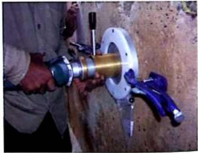
(d) Concrete powder extraction for determination of chloride
