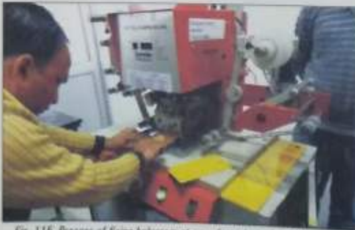
Fig. 115 Process of fixing hologram at manufacturing unit of M/S Shimnit Utsch at Kala Amb (H.P.)
