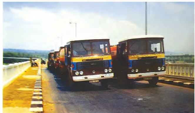
चित्र 2 ब्रह्मपुत्र सेतु पर भार परीक्षण
