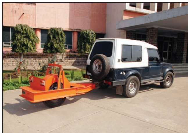
चित्र 4 : स्वचालित सड़क खुरदुरापन रिकार्डर (एफ.डब्ल्यू.बी.आई.)
