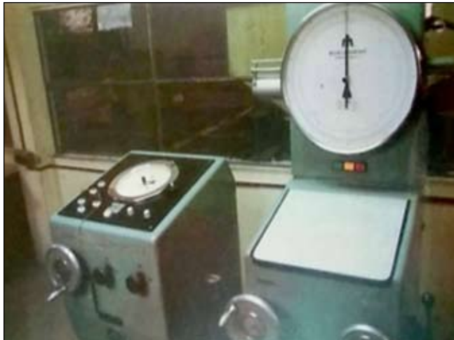
भारण फ्रेम के अधीन आवर्ती परीक्षण संपन्न करने के लिए भारण विकल्प मशीन
