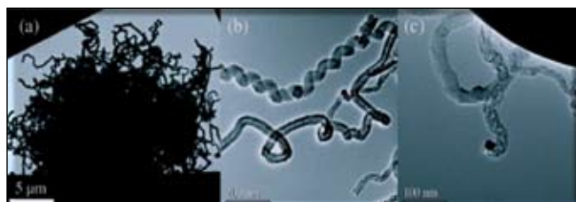
चित्र 22 : CHM संरचना का TEM चित्र (a) कार्बन सामग्री द्वारा सीमेंट कणों का पूरा विस्तार (b) और (c) CNTs मल्ली वाल्ड CNTs और CNFs बनने की प्रक्रिया का प्रदर्शन
